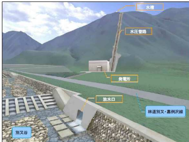
発電所の工事現場。プレハブの事務所や資材、重機などが置かれている。正面の山にタンクと水圧管が設置される。この山の上部に、慰霊碑があった。下図は北電の文書に掲載されている「イメージ図」
